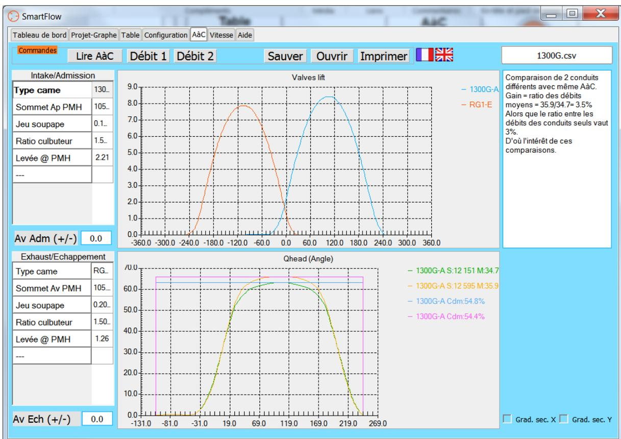
Comparaison de 2 conduits différents avec le même AàC montre un gain de 3.5% (ratio des débits moyens = 35.9/34.7), alors que le ratio entre les débits des conduits seuls valait 3%.
